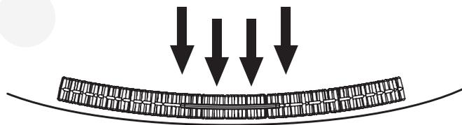
Les tamis Eclipse<sup>MC</sup> sont conçus pour s'adapter à pratiquement toutes les formes et tailles d'urinoir : ils sont assez robustes et flexibles pour couvrir la bassine et le siphon.
